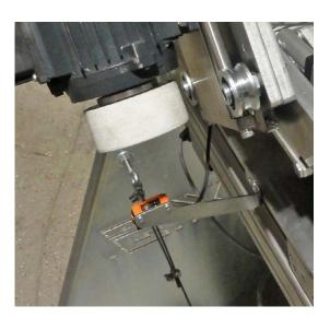
An der Maschine befestigte Sensoren erkennen die Lage des Messers, sowie auch fehlende Klingen. Diese Informationen sorgen für eine kurze Schleifzeit, da die Sensoren fehlende Klingen erkennen und diese dementsprechend übersprungen werden. Am Messerende ändert sich die Drehrichtung des Schleifsteins in Abhängigkeit der Vorschubrichtung und garantiert dadurch ein gradloses Nachschleifen der Schneide.
