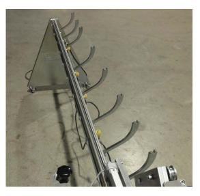
Durch die magnetische Klemmvorrichtung wird das Messer werkzeuglos auf den Schleifautomat aufgespannt.
