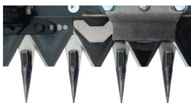
Normální stříh žací lišty rozteč žacích prstů 76,2 mm (3")
