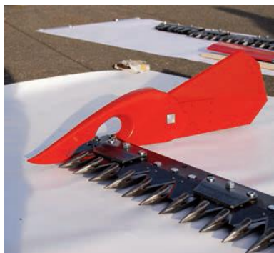
Normální stříh žací lišty rozteč žacích prstů 76,2 mm (3")
