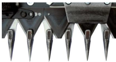
Střední stříh žací lišty rozteč žacích prstů 50,8 mm (2")
