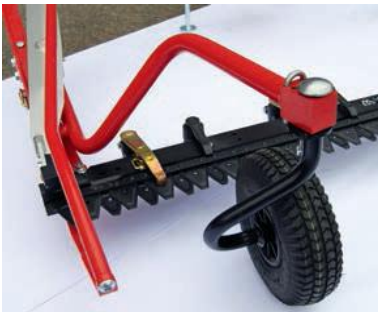
Portálové žací ústrojí, systém ESM Bidux.
