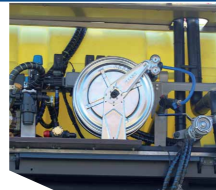
Automatisch aufrollende Schlauchtrommel mit Handlanze
