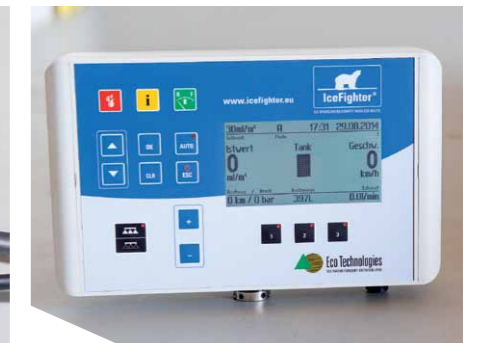
Die Regelung verfügt über ein großes Display und große Tasten, über die sich der Computer intuitiv und leicht verständlich auf 2 Ebenen bedienen lässt.
