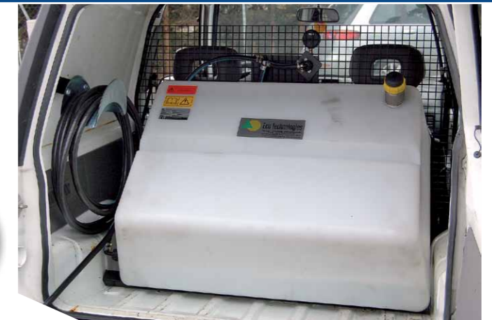
XF-MEP kompakt verbaut im Kofferraum
