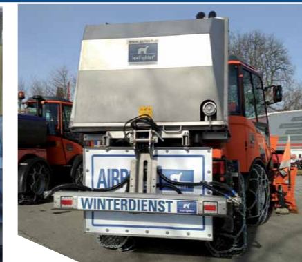
Sprühbalken, Gehäuse und Sprühschutz aus hochwertigem Edelstahl
