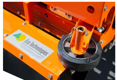
Der Anfahrtschutz verhindert Beschädigungen am Waschbalken durch einen Ausweichmechanismus mit Ablenkrollen.
