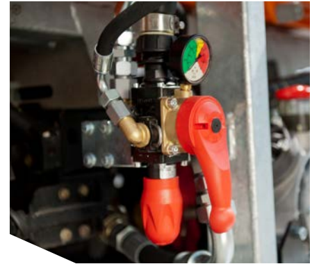
Druckregleinheit mit Umschaltventil für die Wahl zwischen den Funktionen Schlauchtrommel, Waschbalken oder Gießarm.
