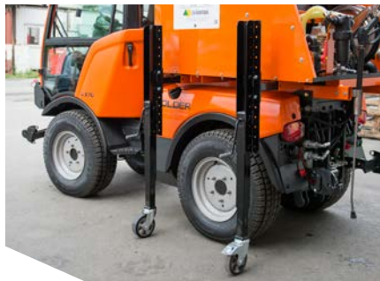
Abstellstützen mit gebremsten Laufrollen zur mühelosen Montage und Demontage des Multiwashes am Fahrzeug.
