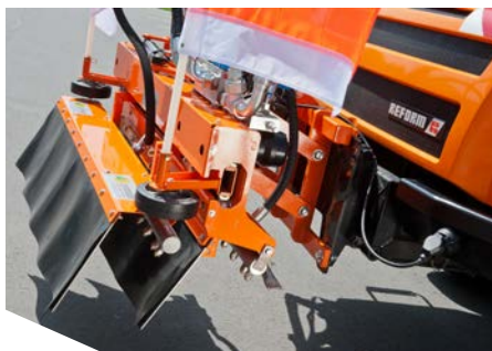
Der Spritzschutz schützt die umliegende Umgebung vor Sprühnebel.
