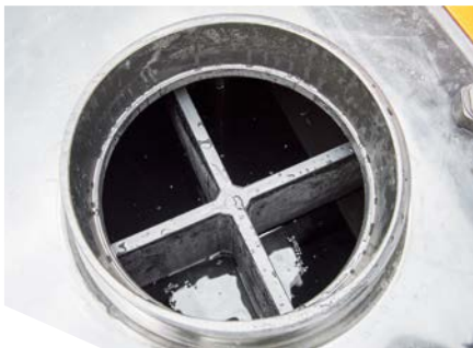
Massive, kreuzweise angeordnete Schwallwände verhindern Gewichtsverlagerungen durch „schwappendes“ Wasser.
