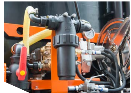
Ablasshahn zum Entleeren des Tanks und Feinfilter.
