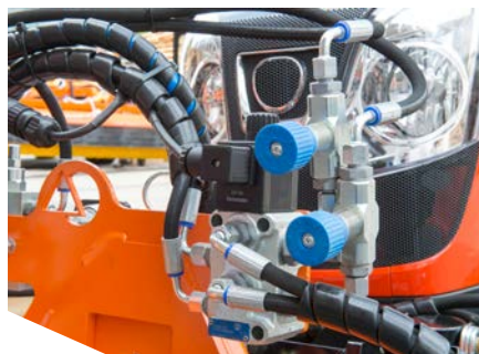
Ventile zum Regeln der Bewegungsgeschwindigkeit des Gießarms.
