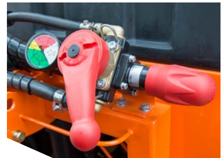
Druckregleinheit mit Umschaltventil für die Wahl zwischen den Funktionen: Schlauchtrommel, Waschbalken oder Gießarm.
