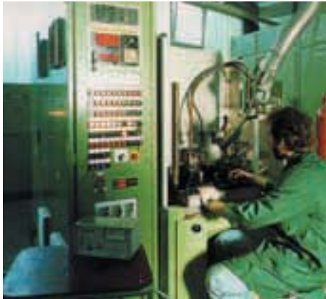
CNC-Induktionshärteanlage, Hochfrequenzgenerator 40 kW, Schaltsteller-Automatik.
