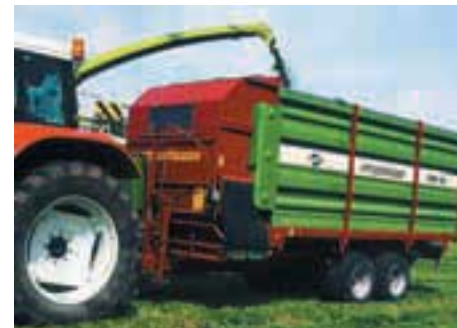
Der Futtermischwagen wird von oben befüllt.
