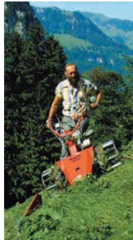
Rapid Mäher 306: Überlastsicherung gegen Klingen- und Fingerbrüche.
