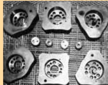
Feinstanzstempel aus Schnellarbeitsstahl. Werkstoff-Nr. 1.3343.
