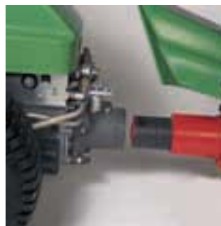
Werkzeugloses Schnellwechselsystem für Anbaugeräte.
