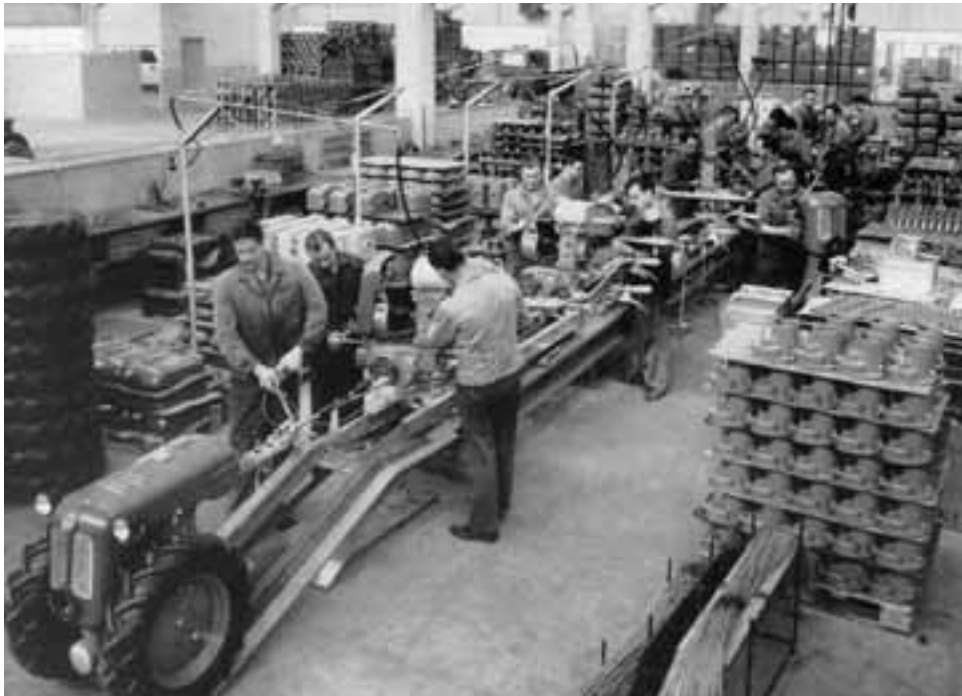
Montageband 4-Rad-Fahrzeuge mit geländegängigem Alltrac 450.
