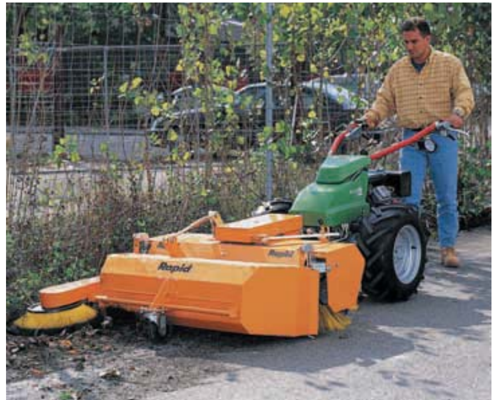
Rapid Euro-Combi mitkehrbürste und automatischer Schmutzaufnahme.
