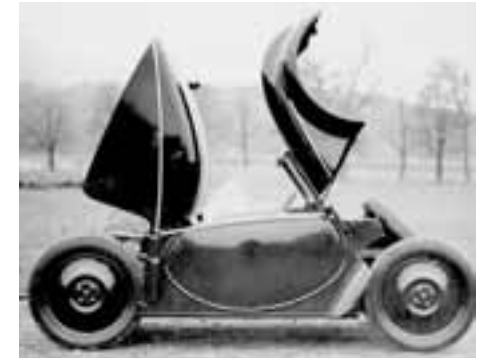
Vorderteil und Heckhaube zusammen mit den Kotflügeln aufklappbar.
