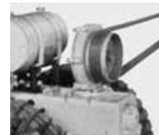
«Durch die Riemenscheibe kann der Kleintraktor zum Antrieb der verschiedensten Maschinen eingesetzt werden.»
