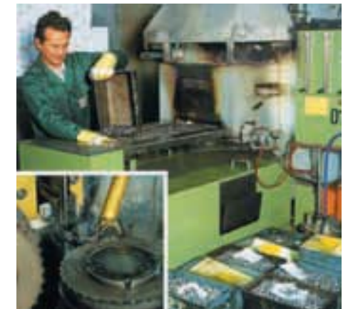
Angepasste Härteverfahren (Induktivhärten bzw. Einsatzhärten im Durchgangsofen).
