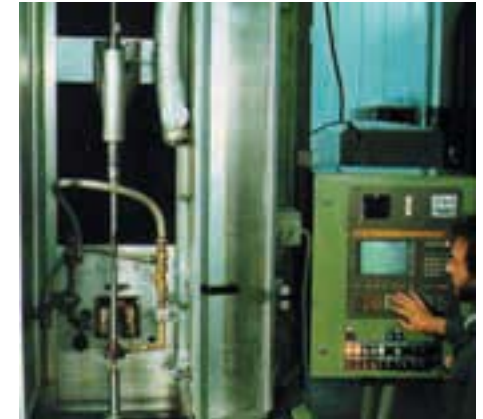
CNC-Induktionshärteanlage, Mittel- und Hochfrequenzgenerator 50 kW, für Wellen und Profilleile bis 1200 mm Länge.
