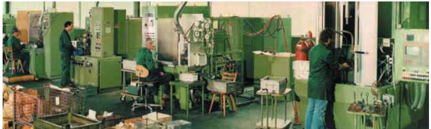
CNC-gesteuerte Induktions-Härteanlagen im Betrieb Wehingen.
