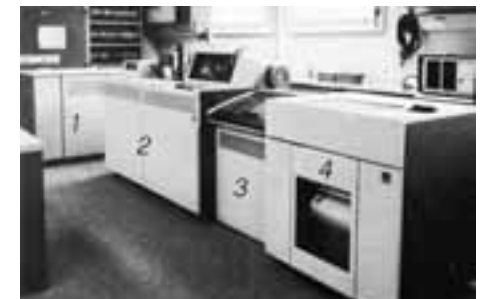
Die erste IBM S/38 mit Magnetplattenspeicher (1), Zentraleinheit IBM S/38 (2), Magnetband (3), Zeilendrucker (4) und 39 Bildschirmen (1983).
