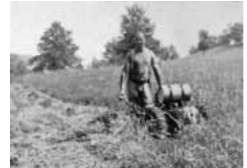
«Kein Vormähen. Mähen am Hang, links und rechts von Bäumen, was mit keiner Maschine mit seitlichem Mähbalken möglich ist. Unbehinderter Abfluss des höchsten und dichtesten Grases.»
