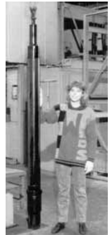
Auch bis 4 Meter lange Teile können Tennifer-behandelt werden.
