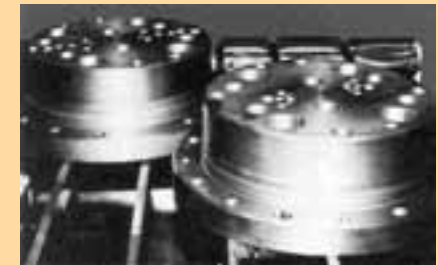
Druckstücke aus hochlegiertem Kaltarbeitsstahl. Werkstoff-Nr. 1.2363.
