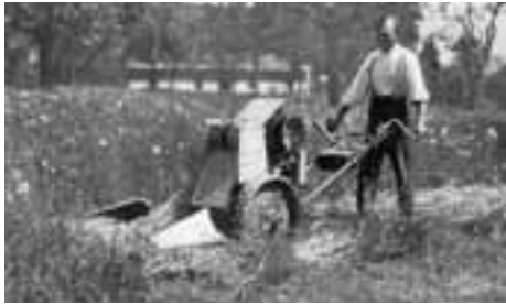
Durch A. Rutishauser verbesserte Motormäher-Konstruktion. Besondere technische Schwierigkeiten bot die Lösung des Problems der Grasverteilung auf zwei Mahden mittels Verteilerhaube.
