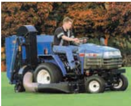
Kleintraktor Iseki mit Zwischenachs-Mähwerk und Grasabsaugung.
