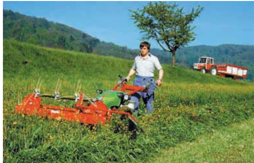
Der Rapid 505 mit Bandedgraser für ladewagengerechte Doppelmahden.
