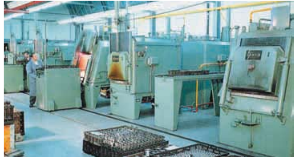
Durchstoss-Kammeröfen für das Einsatzhärten.
