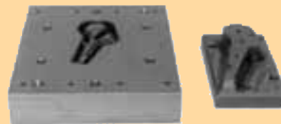
Gesenk für medizinisches Implantat aus Warmarbeitsstahl 1.2344.
