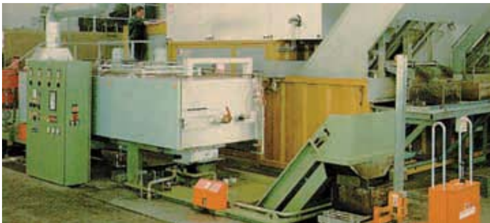
Härtedurchlaufanlagen mit Schutzgasatmosphäre.
