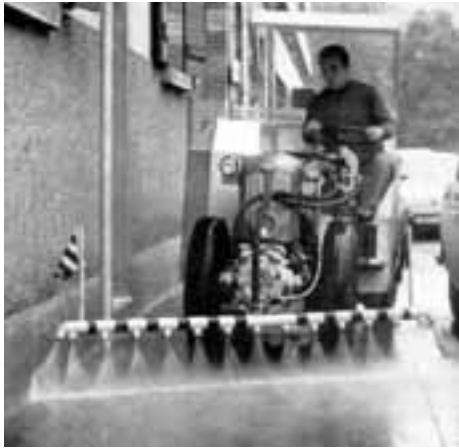
Rapid Schwemm-Maschine. Als Zugkopf dient der Rapid Einachstraktor 12 PS.
