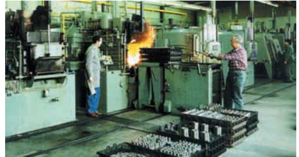
Durchstoss-Kammeröfen (Gasatmosphäre) im Betrieb Urdorf.
