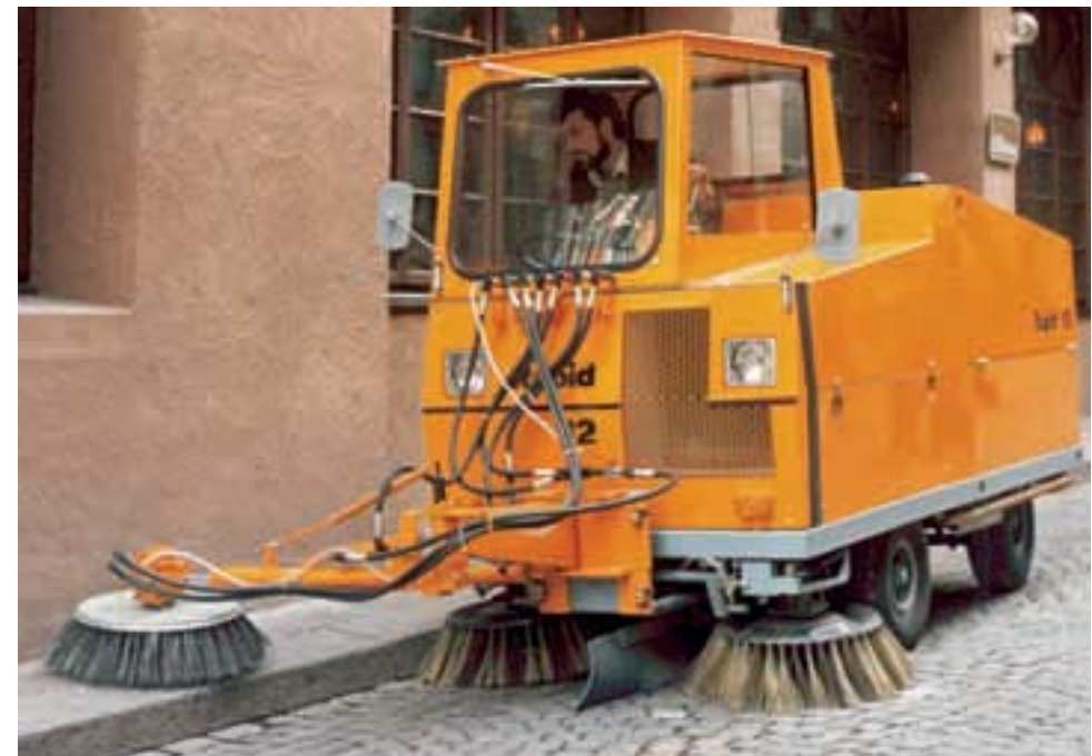
Kehrsaugmaschine Rapid 12 mit dem von Rapid entwickelten dritten Besen.
