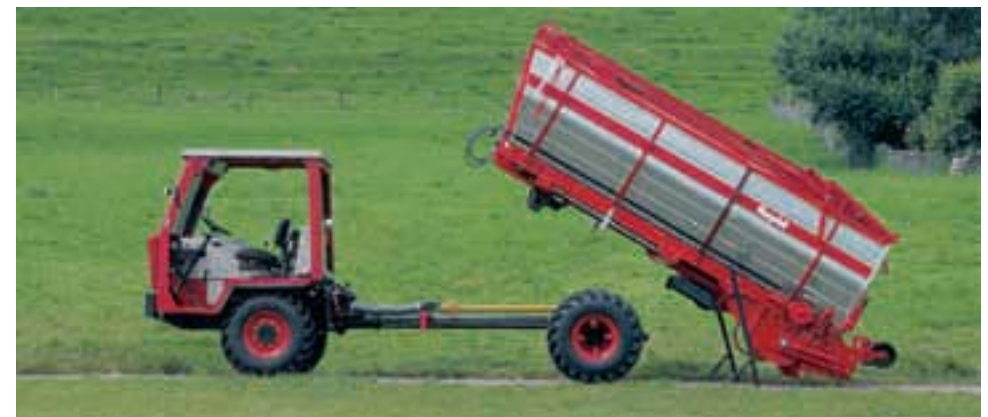
Heckklader werkzeuglos absattelbar.
