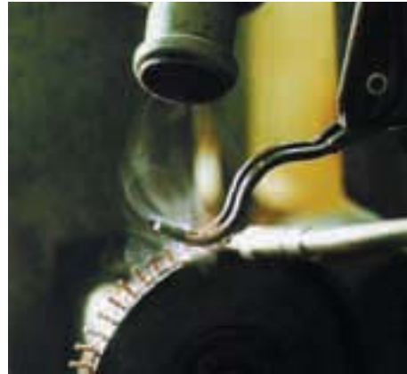
Induktionsanlage, Hochfrequenzgenerator 30 kW, Rundtisch-Automatik für dünne Teile geeignet.
