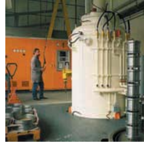
Plasmanitrieranlage im Werk Urdorf.
